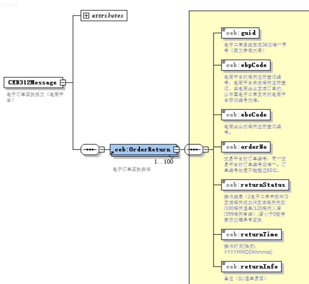
图 3-2 订单回执报文的结构
