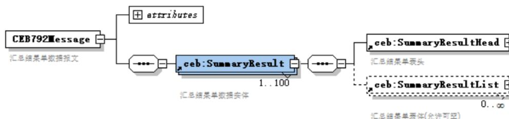
图 2-23 汇总结果单报文的结构
