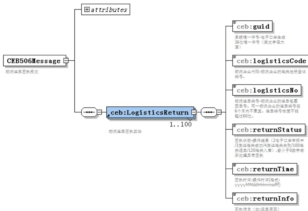
图 2-6 运单回执报文的结构
