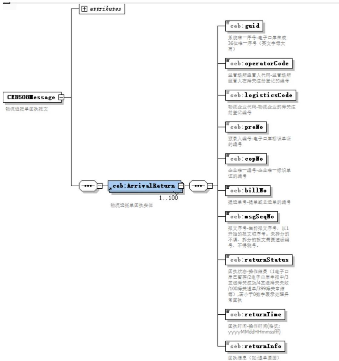
图 2-8 运抵单回执报文的结构
