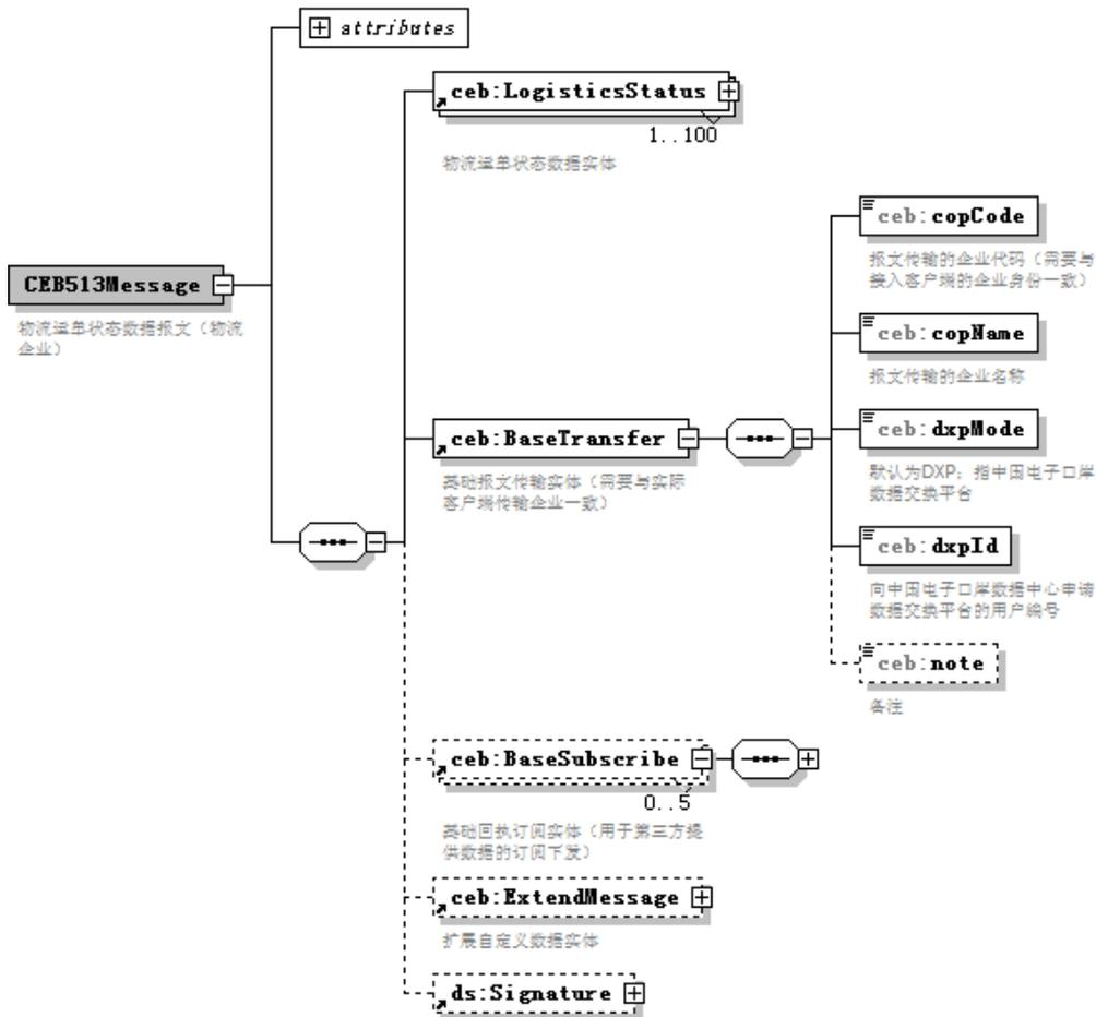
图 3-7 运单状态报文的结构
