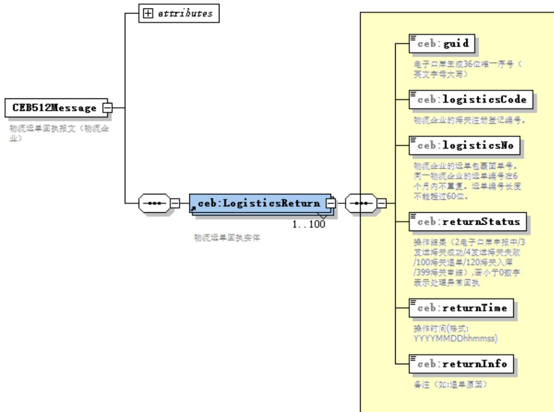
图 3-6 运单回执报文的结构
